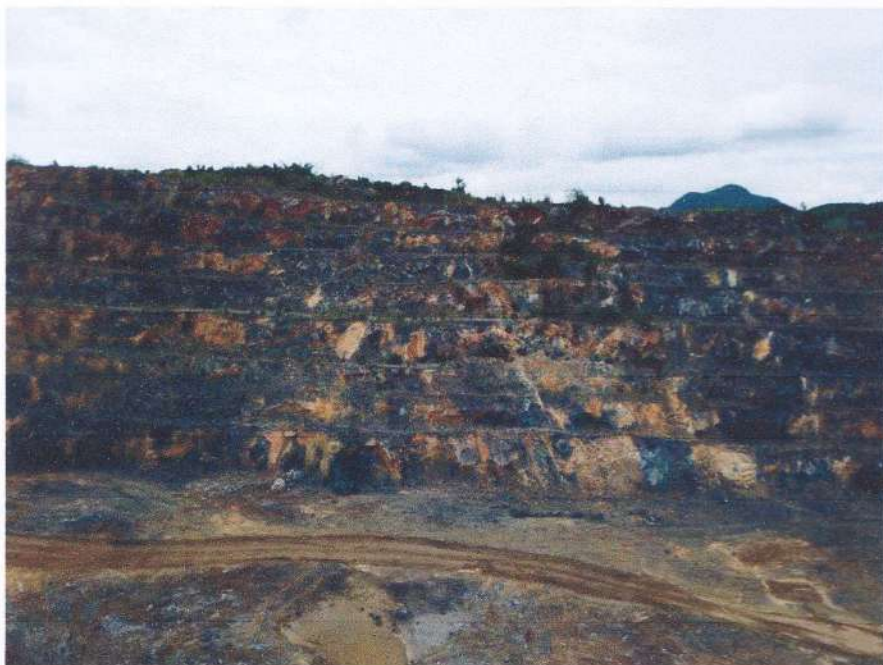
รูปที่ 9 แสดงสภาพพื้นที่หน้าเหมืองบริเวณตอนกลางประทานบัตร ระหว่างหมุดเหมืองแร่ที่ 6-7 มีการทำเหมืองเป็นแบบขั้นบันได ภาพนี้ถ่ายจากบริเวณตอนกลางหน้าเหมือง มองไปทางทิศตะวันออก
